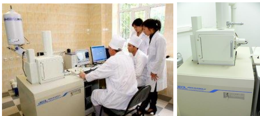
Сурет 2.9 Сканерлеуші растр электронды микроскопы
