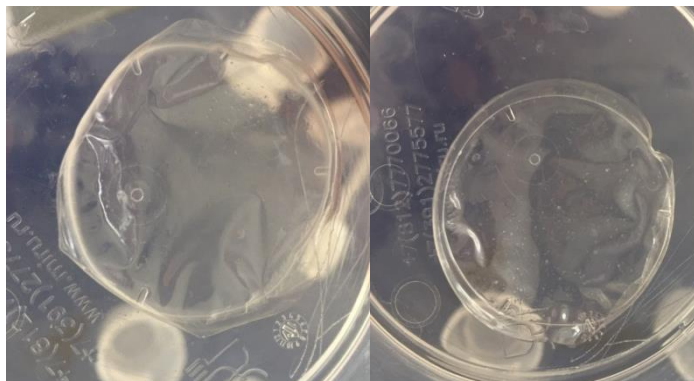
Сурет 2.8 ПВС полимерінің лабораторияда алынған үлгілері
