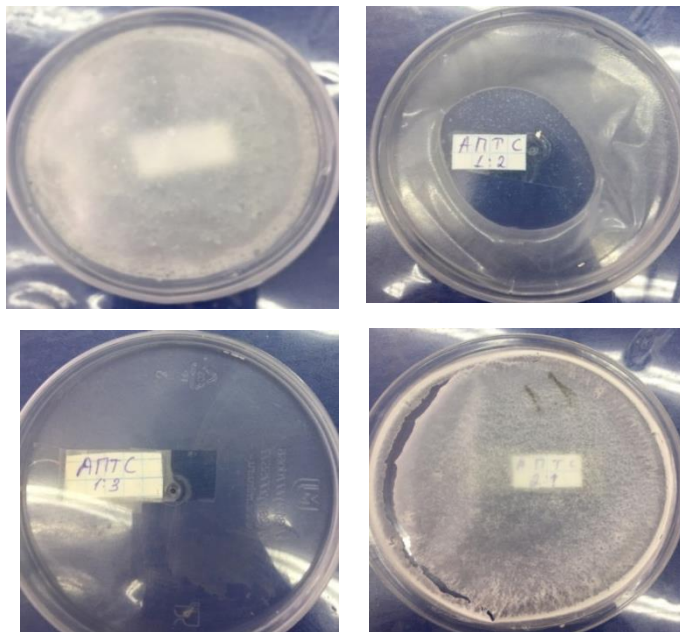
Сурет 2.2 АПТС – ПВС полимерінің лабораторялық жағдайда алынған үлгісі
